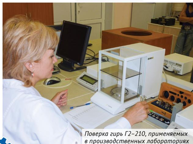
Поверка гирь Г2-210, применяемых в производственных лабораториях
