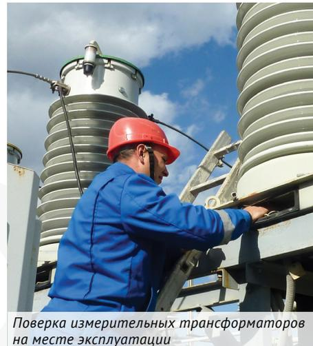
Поверка измерительных трансформаторов на месте эксплуатации
