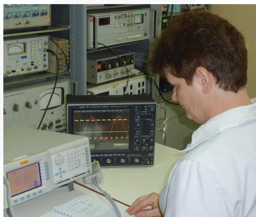
Поверка цифровых осциллографов, применяемых для исследования параметров электрических сигналов
